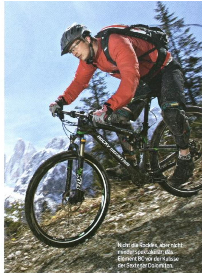
Kletterhilfe: Die Fox-Talas-Federgabel lässt sich von 120 auf 90 mm absenken.
