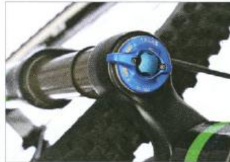
Kletterhilfe: Die Fox-Talas-Federgabel lässt sich von 120 auf 90 mm absenken.
