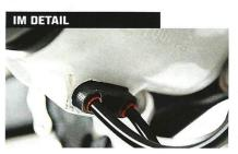
Zugwechsel: Einfach die Abdeckkappe am Tretlager entfernen, schon lassen sich die Schaltzüge aus dem Rahmen angeln.
