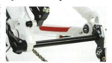
Der Steifigkeit zuliebe bedient sich auch das Element der X-12-Steckachse von Shimano. Für noch mehr Steifigkeit sorgen neue Gleitlager in allen Drehoelenken, die nebenbei noch 120 Gramm Gewicht sparen.
